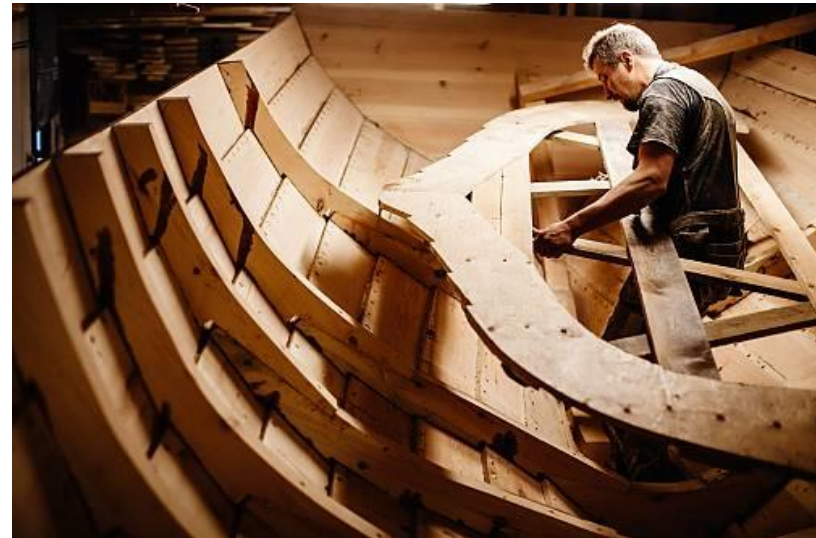
Limisaumaisen puuveeneen rakentamista. / Constructing a wooden clinker boat. Photo: Jaska Poikonen
