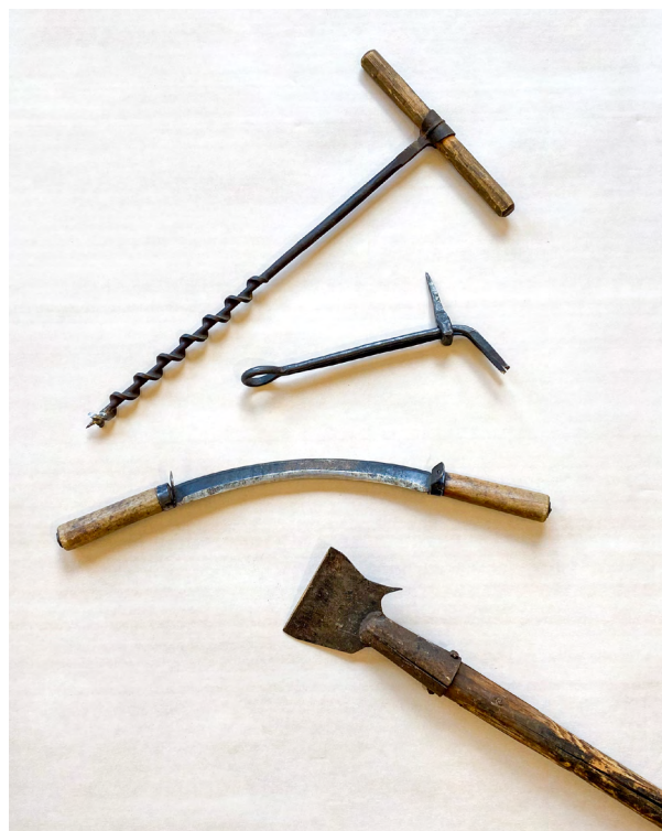
Kuva 4: Työkaluja hirsirakentamiseen: Ylinnä pora tapituksen reikien poraukseen. Sen alla varauksen piirtämiseen tarkoitettu kaksipiikkinen hirsivara ja kuorimarautatukkien kuorimiseen. Alimpana petkele, jota on myös käytetty puun kuorimiseen.
