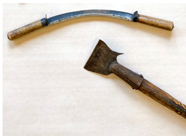
Kuva 15: Puun kuorimistyökalut eli parkkuurautat. Ylempänä pantaveitsi ja alempana petkele.
