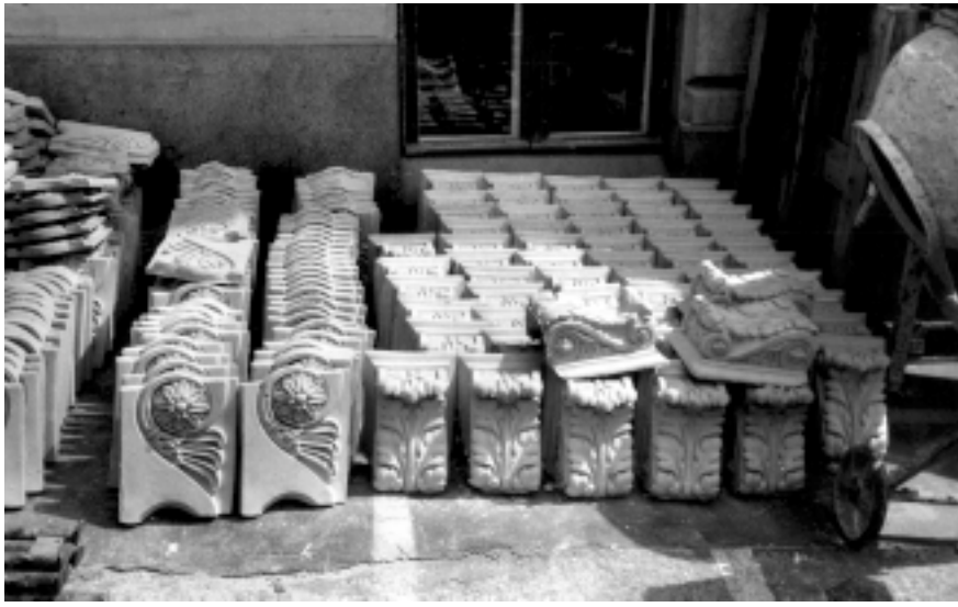
Kuva 11. 1800-luvun kivitalojen julkisivujen koristelussa käytettiin paljon kipsistä valettuja koristeosia, jotka kiinnitettiin paikoilleen rappaus töiden jälkeen. Kipsikoristeiden valmistaminen ja kiinnittäminen on alan erikoisammattilaisten työtä. Kipsikoristeiden kiinnitys tulee tarkastuttaa muutaman vuoden välein ja aina silloin, kun räystäällä tai seinällä on ollut vesivuotoja tai rakennus on liikkunut ja seiniin on ilmaantunut halkeamia.
