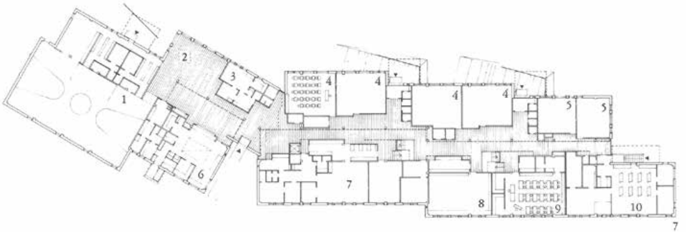
Arkkitehtien Kari Järvinen ja Timo Airas suunnittelema Sunan koulu valmistui vuonna 1985. Koulu on tyypiltään keskikäytäväkoulu ja siinä on myös solukoulun piirteitä. Koulun pohjakerros. Arkitehti 6/1986.
